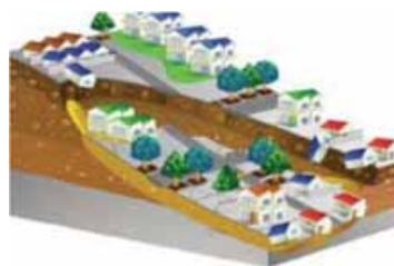
谷埋め型盛土造成地
