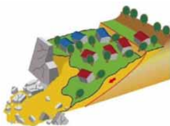
腹付け型盛土造成地
