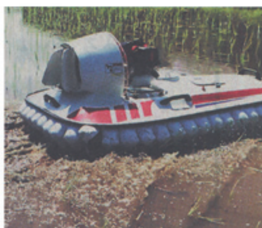
ホバークラフトの空気噴射で水田除草
