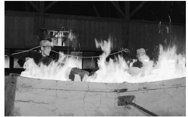
▲炉に砂鉄を装入する木原村下(左)と渡部村下(右)
