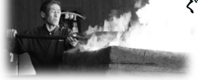
▲燃え盛る炉に砂鉄を投入する本原さん
