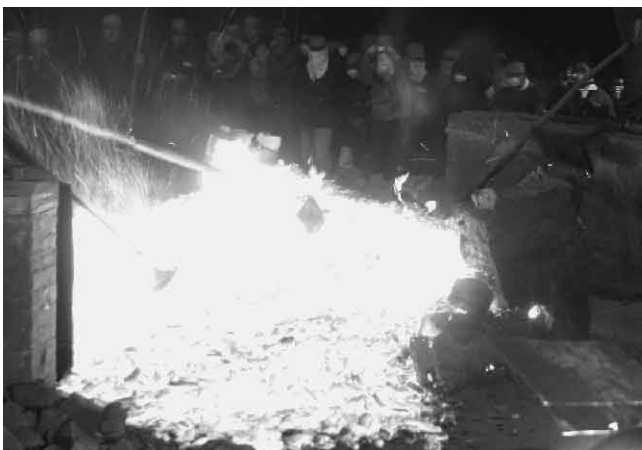
▲ たたら炉を壊しケラ出し
